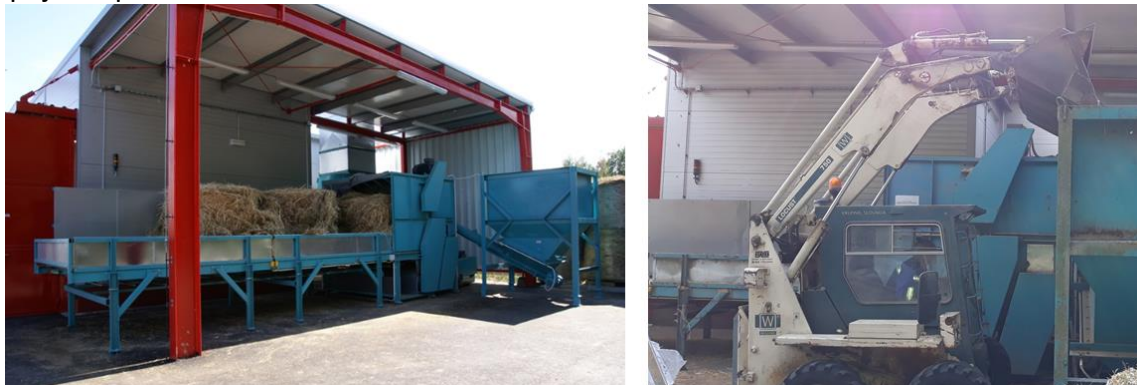
Obr. 6 Rozdužení, drcení a míchání směsi pro výrobu pelet (ProPelety.cz, 2020)
