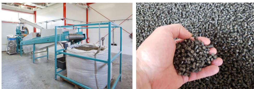
Obr. 7 Peletování, očištění a ochlazení vyrobených pelet (ProPelety.cz, 2020)
